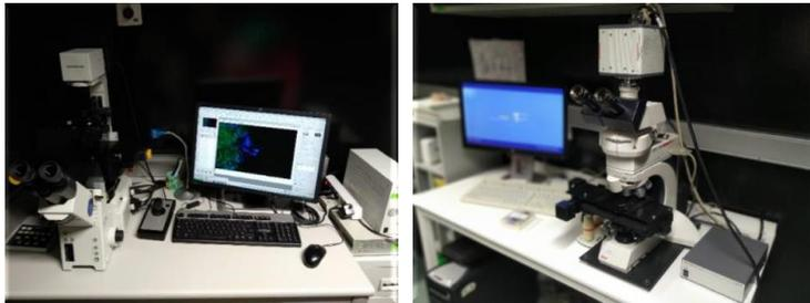
Dos equipos: microscopio invertido Olympus IX81, y microscopio directo binocular LEICA DMLA.
